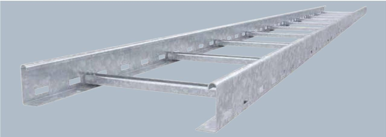
Kabelleiter in Seitenhöhe 60 mm mit eingeschweißten, nach oben offenen C30 Profilsprossen. Eingerollter Seitenholm zur Verstärkung und als Kantenschutz. Die Befestigung auf dem Ausleger erfolgt mit Klemmstücken Typ LKS 40. Das Schlitzmaß der Sprosse beträgt 16,5 mm, die passende Bügelschelle ist der Typ 2056.
