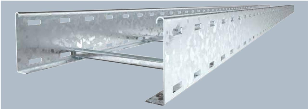
Kabelleiter in Seitenhöhe 110 mm mit eingeschweißten, nach oben offenen C30- Profil Sprossen. Eingerollter Seitenholm zur Verstärkung und als Kantenschutz. Die Befestigung auf dem Ausleger erfolgt mit Klemmstücken Typ LKS 40. Das Schlitzmaß der Sprosse beträgt 16,5 mm, die passende Bügelschelle ist der Typ 2056.
